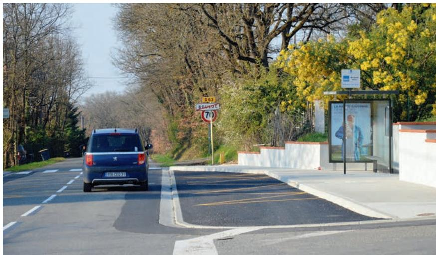
Les travaux ont été complétés par la mise aux normes pour les personnes à mobilité réduite de l'arrêt de bus existant et par la création d'un arrêt en vis-à-vis. Un aménagement pour un passage piéton marqué au sol et un petit aménagement minéral sont prévus à l'inter-
